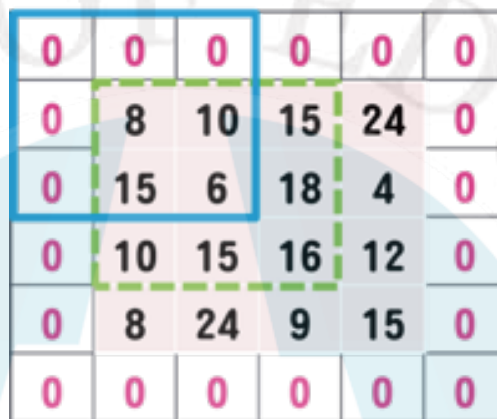
圖6-11 藉由邊緣補零強化特徵圖邊緣的影響力
