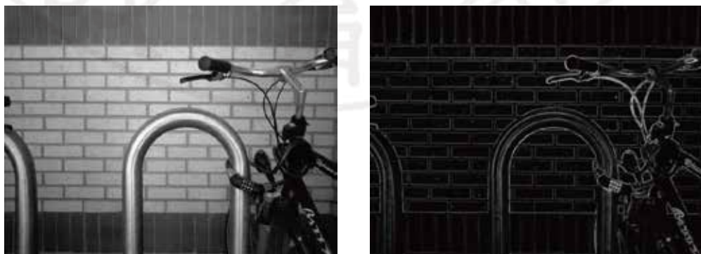
圖6-8 左邊為原圖；右邊為經過Prewitt kernel卷積運算後的圖像
