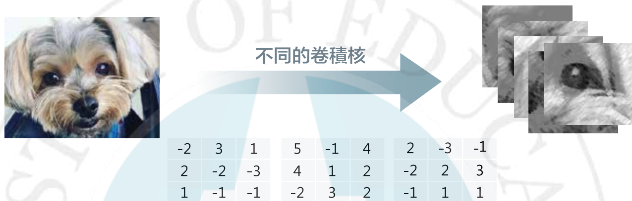
圖6-7 藉由不同的卷積核萃取出原始影像中的各種特徵
